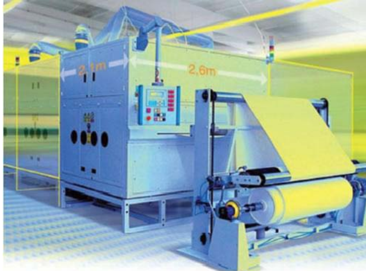
Figura 4.3 - Sistema Elmarco para a produção industrial de nanofibras [42] .
