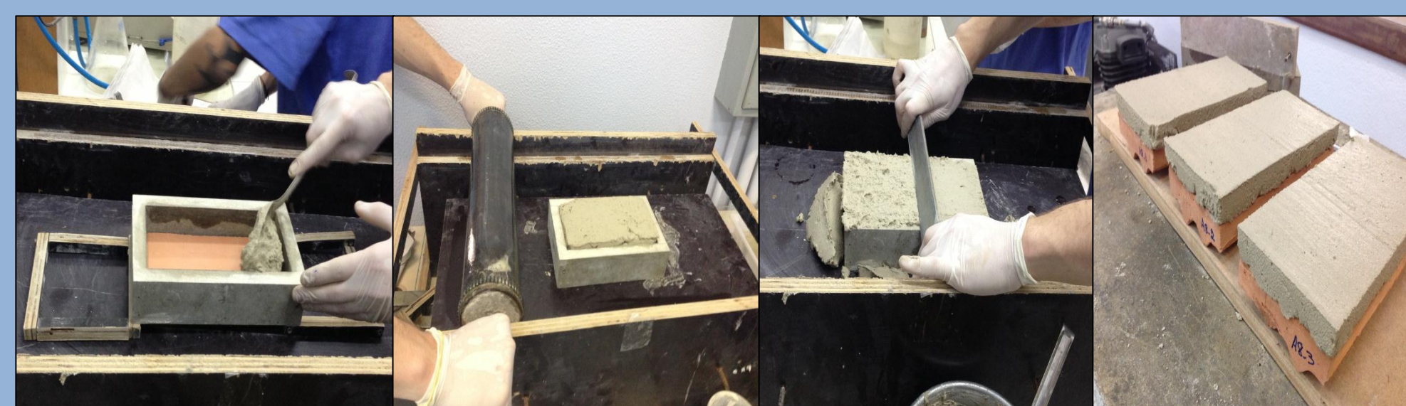
Aplicação da argamassa e corpos de prova
