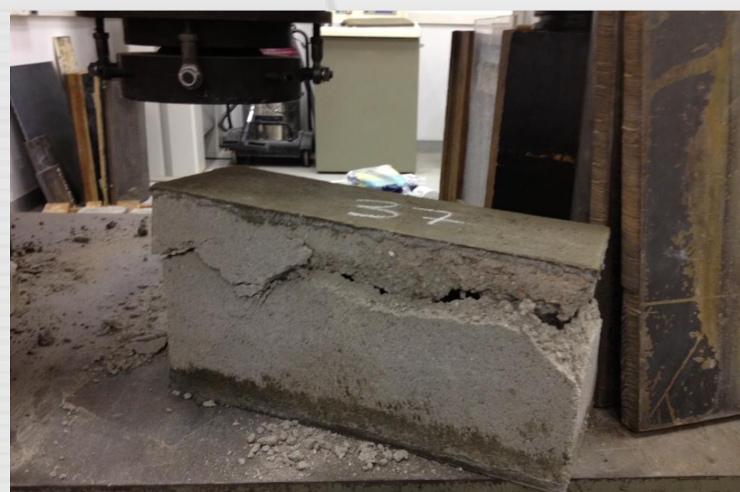
Ensaio de resistencia à compressão do bloco de concreto
