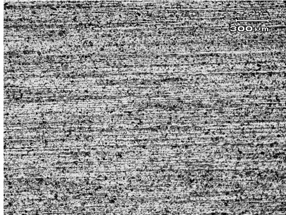
Figura 4: Fio-máquina aspecto longitudinal do fio-máquina, estrutura perlítica (região escura) e ferrita (região clara), ataque Nital 2%, aumento 50X.
