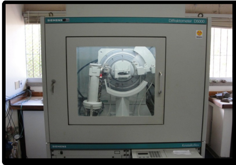
Figura 6: Difratorômetro de Raio-X Siemens - Laboratório de Difração de Raios-X (DRX)-IGeo/UFRGS
