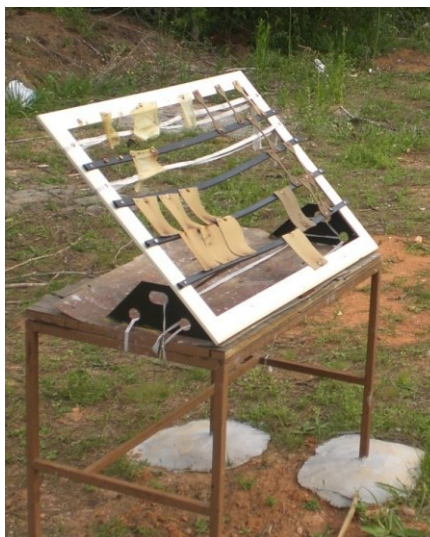
Figura 17 - Sistema de exposição das amostras ao intemperismo natural.
