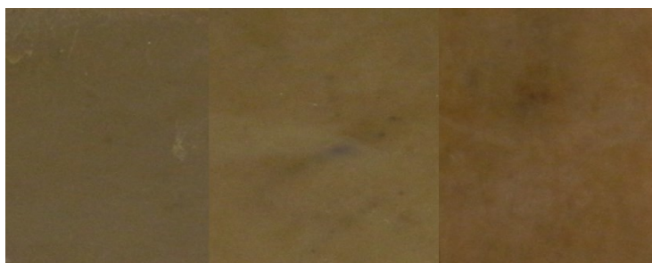
Figura 33 - Amostra de NR Pura sem exposição (à esquerda), degradada naturalmente por compostagem sem envelhecimento prévio (centro) e degradada naturalmente por compostagem com envelhecimento prévio (à direita).
