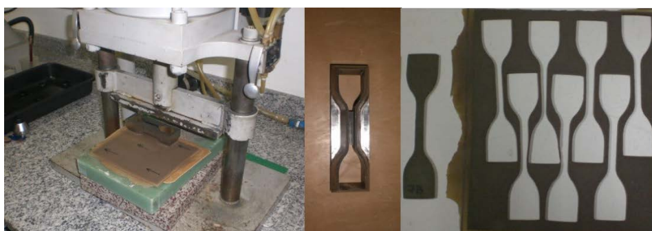
Figura 20 – Balancim e cunhas utilizados para o corte das amostras no formato de acordo com a normatização.
