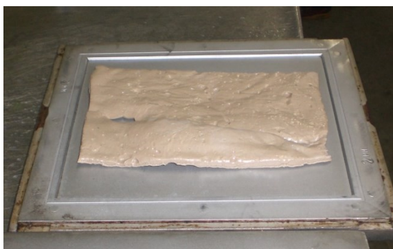
Figura 12 – Carregamento do molde com a mistura de borracha natural.
