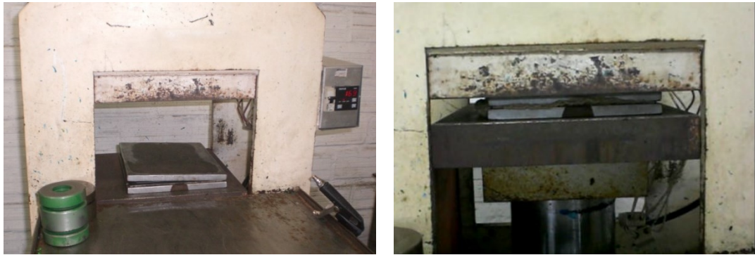
Figura 13 – Processo da moldagem por compressão.
