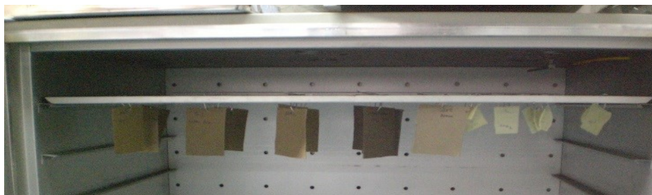
Figura 18 – Amostras posicionadas para o envelhecimento acelerado em estufa.
