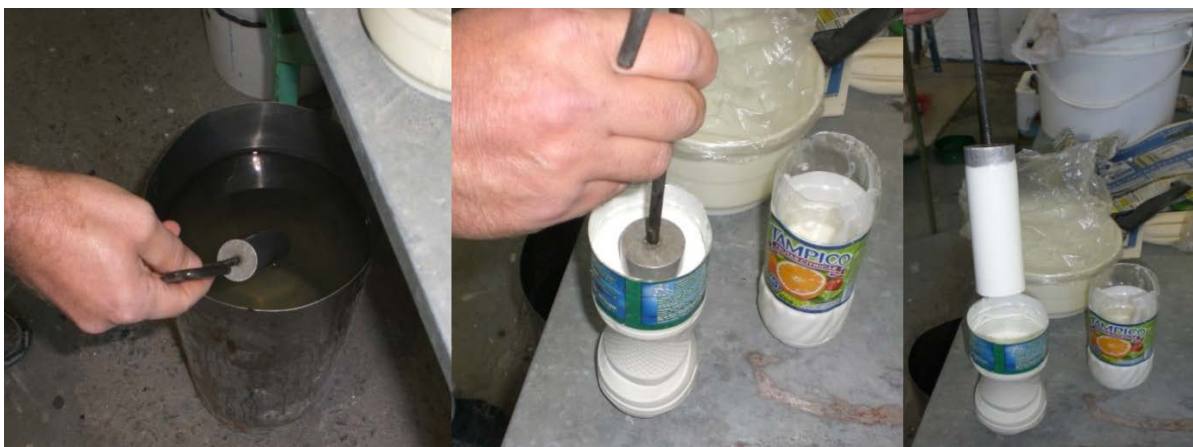
Figura 15 - Processo de imersão para fabricação das amostras em látex de borracha natural.
