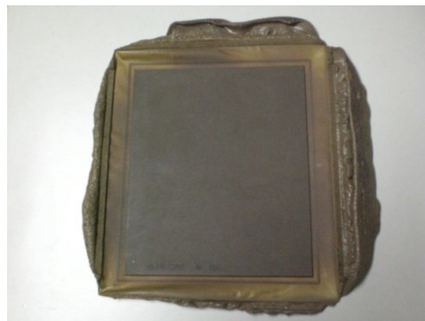
Figura 14 – Lençol de borracha natural obtido.
