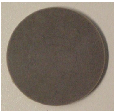
Figura 10 - Corpo de prova fabricado por compressão a 170°C durante 5min.
