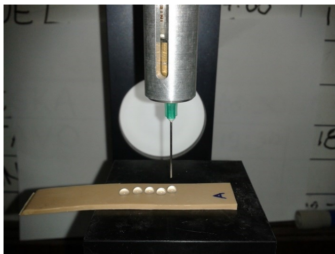
Figura 23 – Deposição das gotas de água com auxílio de uma micro seringa sobre o substrato de borracha natural.
