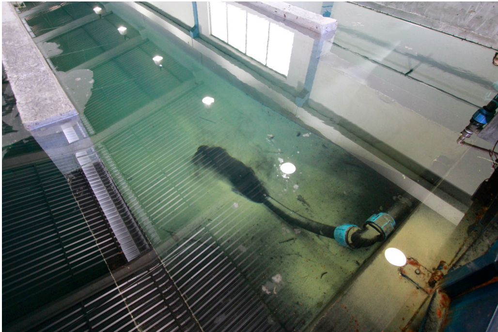
Figura 23 – Injeção de corrente de turbidez no tanque experimental
