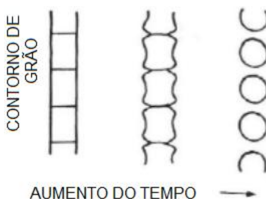
Figura 3.17 Desenho esquemático do mecanismo de esferoidização segundo a teoria do entalhe térmico (21).
