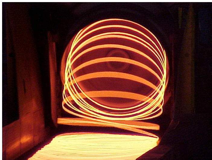
Figura 4.2 Imagem da bobina ao deixar o formador de espiras em uma condição padrão de processo.
