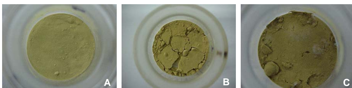
Figura 5.18. Aspecto macroscópico de produto seco de A. saturoioides antes da exposição à umidade (A), e após 11 dias de exposição à UR de 65 % (B) ou UR de 99 % (C).
