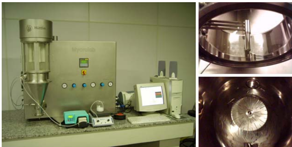
Figura 4.1. Leito fluidizado Hüttlin, modelo Mycrolab; em detalhe o aspersor tipo top spray e o distribuidor de ar.
