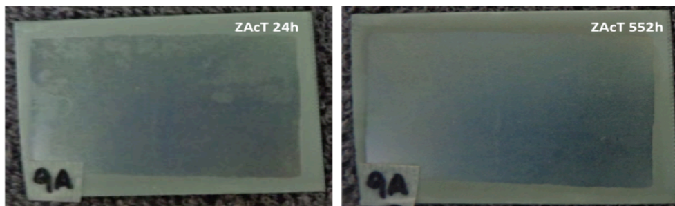
Figura 31: Imagens da amostra de aço zincado em meio ácido e revestida com cromatização trivalente após 24 horas e 552 horas de ensaio em câmara úmida.
