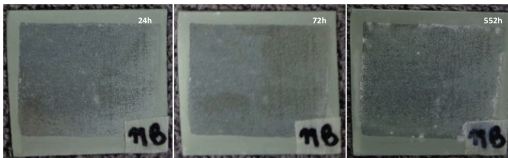
Figura 30: Imagens da amostra branco do aço zincado em meio ácido após 24 horas, 72 horas e 552 horas de ensaio em câmara úmida.
