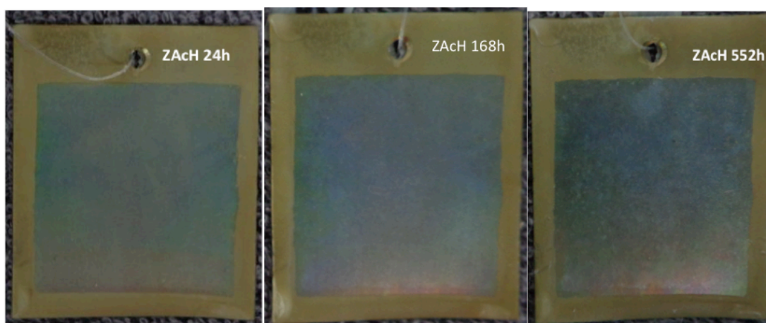
Figura 46: Imagens da amostra de aço zincado em meio alcalino revestida com cromatização hexavalente após 24 horas, 168 horas e 552 horas de ensaio em câmara úmida.
