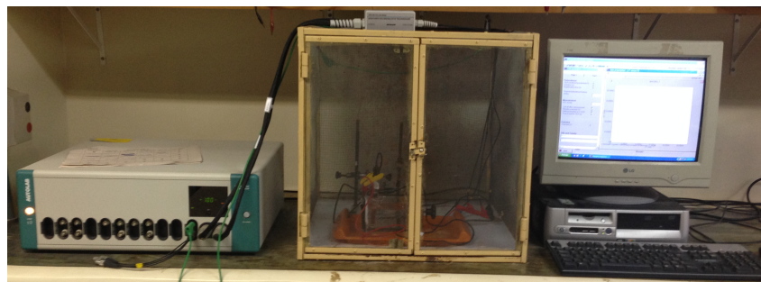
Figura 8: Potenciostato e célula eletroquímica.
