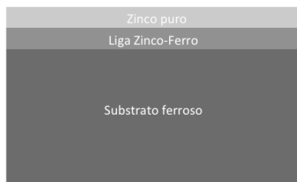
Figura 2: Camadas de liga zinco-ferro e zinco puro formadas no substrato.
