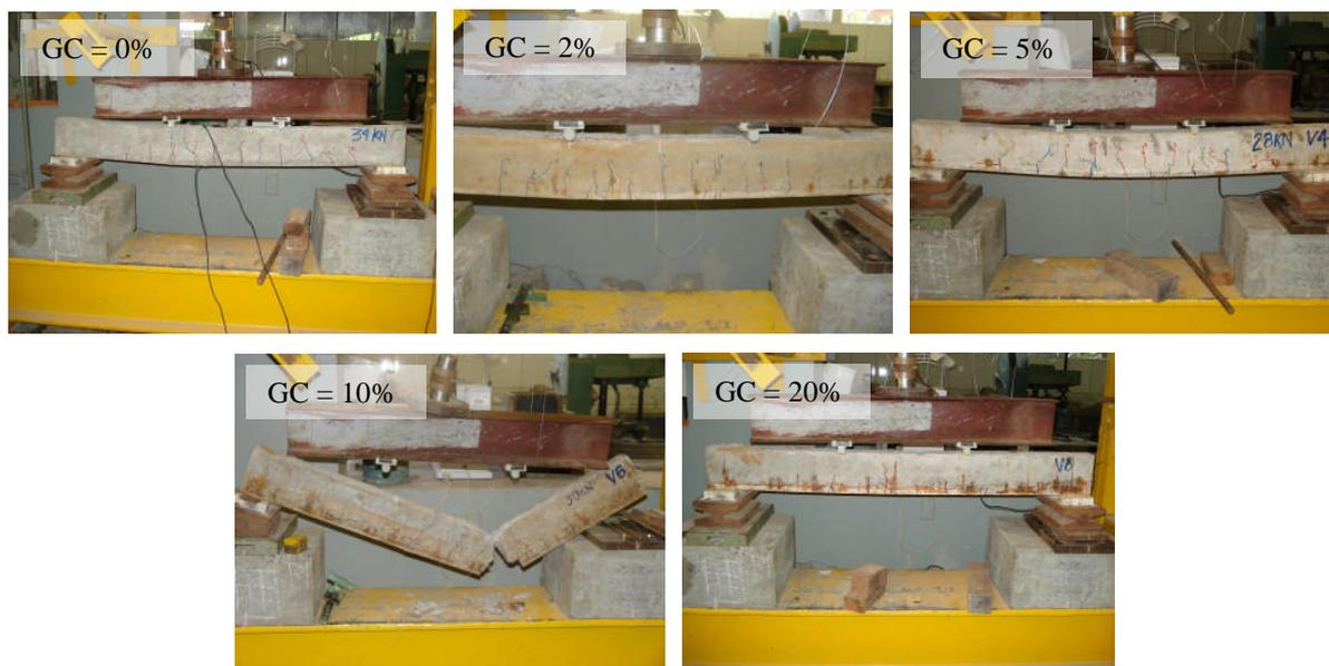
Figura 5.43 – Vigas após a ruptura.
