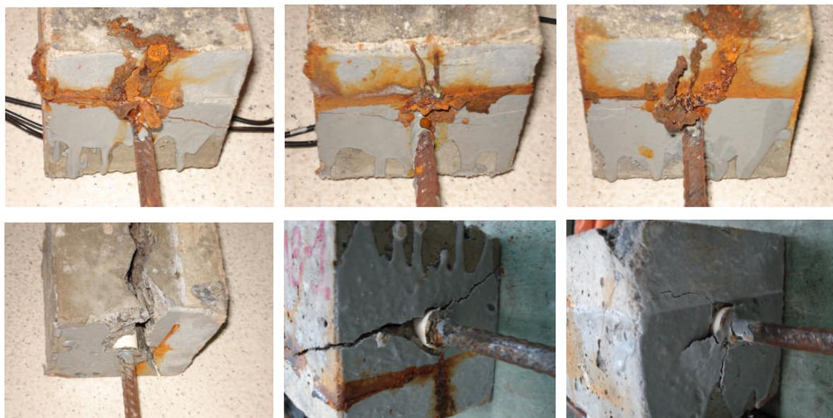
Figura 5.9 – Corpos-de-prova de 10% de GC antes e após o arrancamento.
