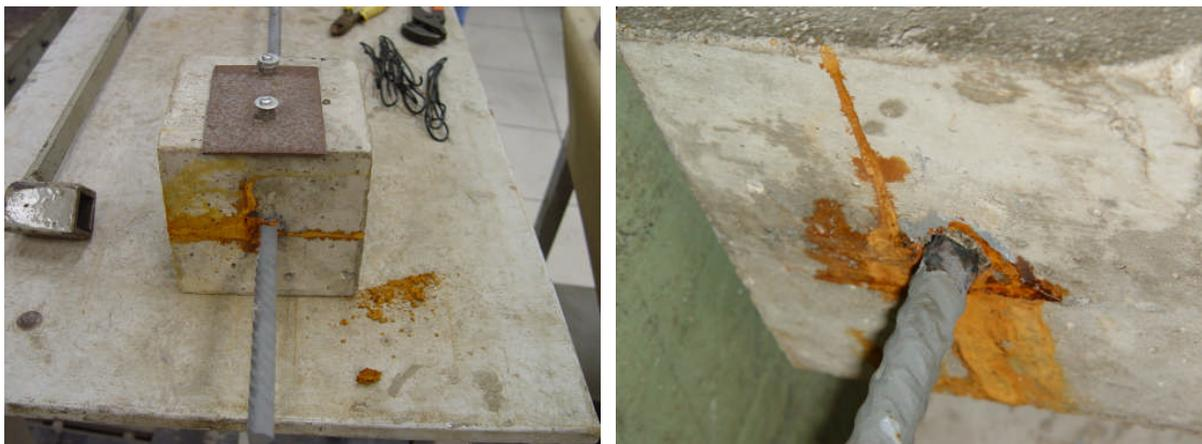
Figura 5.14 – Corpos-de-prova com 2% de GC antes e após o arrancamento.
