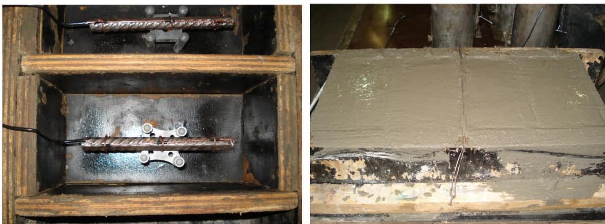
Figura 3.6 – Fôrmas antes e após concretagem dos corpos-de-prova de calibração.
