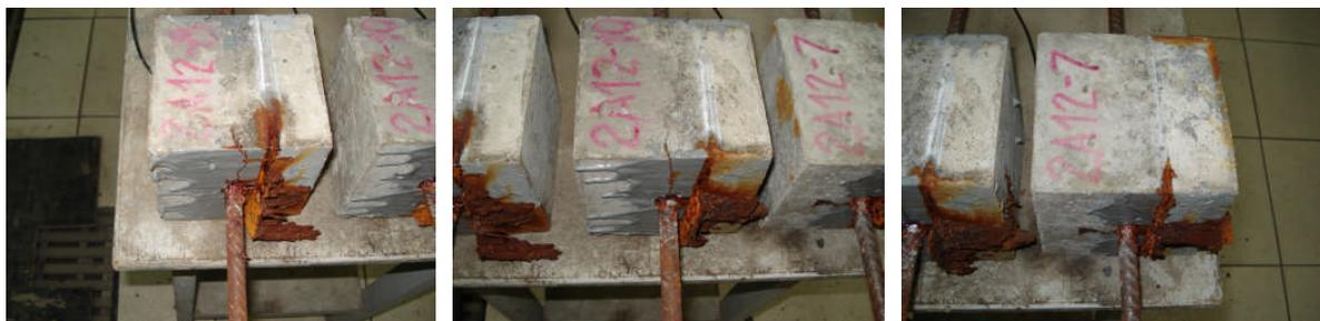
Figura 5.18 – Corpos-de-prova com 20% de GC antes do arrancamento.
