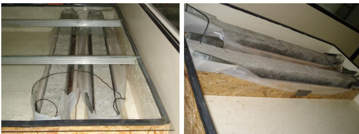
Figura 3.25 – Vigas em processo de aceleração de corrosão na caixa estanque.
