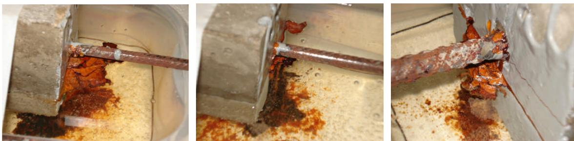
Figura 5.8 – Corpos-de-prova ao final do processo de aceleração com 10% de GC.
