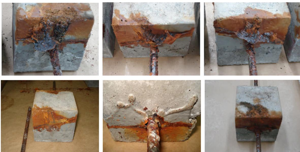
Figura 5.11 – Corpos-de-prova com 20% de GC antes e após o arrancamento.
