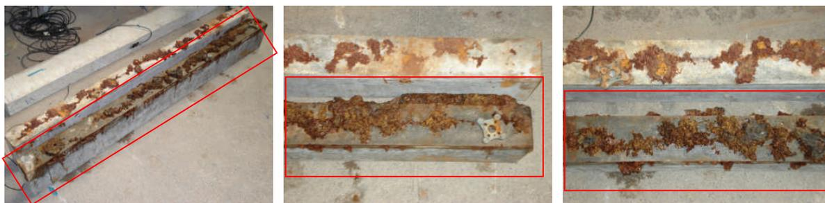
Figura 5.39 – Viga com 20% de GC.
