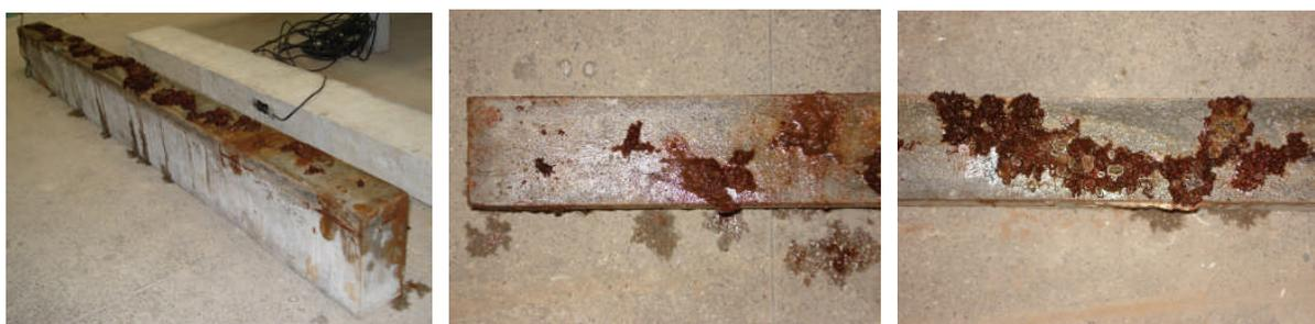
Figura 5.37 – Viga com 5% de GC.
