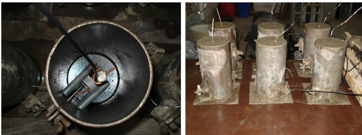
Figura 3.21 – Corpos-de-prova para tensões de tração antes e após a concretagem.
