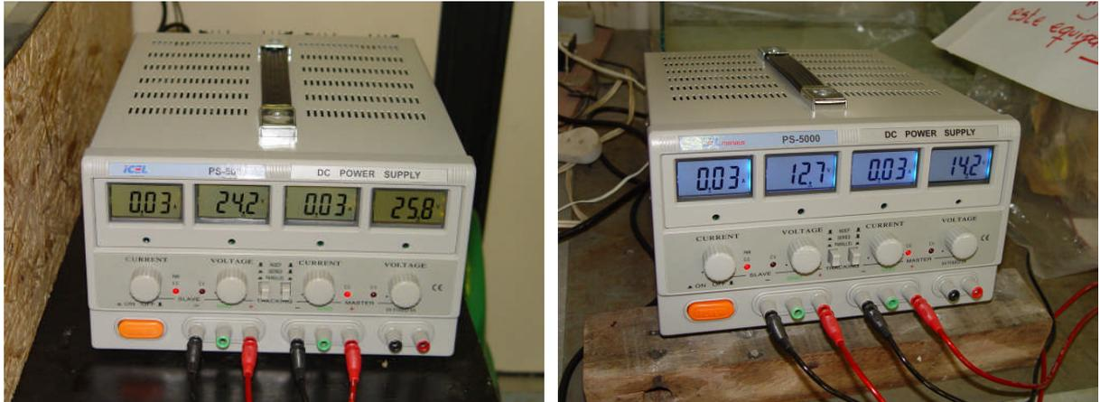
Figura 3.1 – Fonte de alimentação que fornece corrente ou tensão constante.
