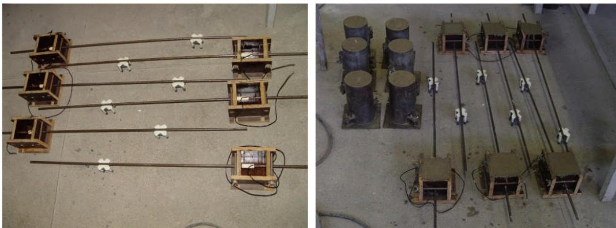
Figura 3.15 – Corpos-de-prova de arrancamento antes e após a concretagem.
