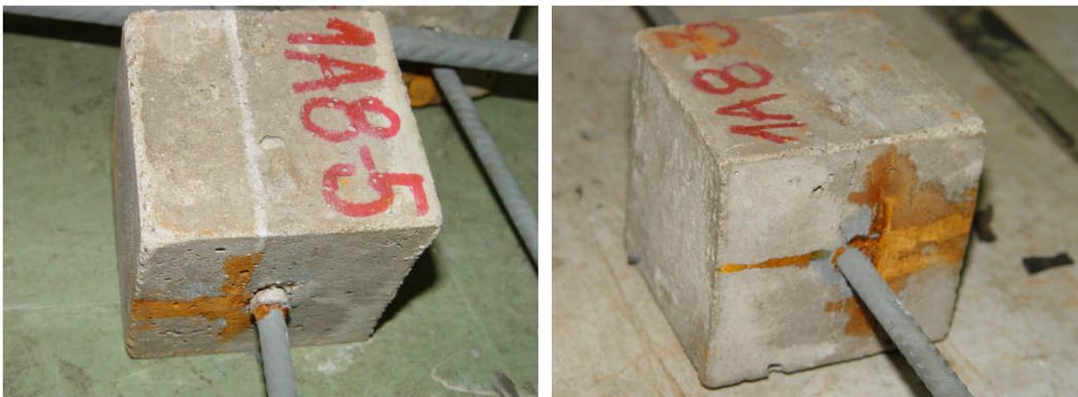
Figura 5.5 – Corpos-de-prova de 2% de GC após o arrancamento.
