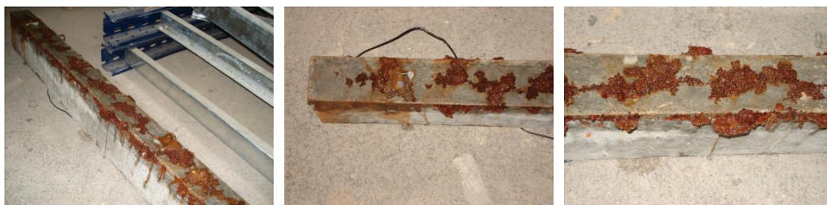
Figura 5.38 – Viga com 10% de GC.
