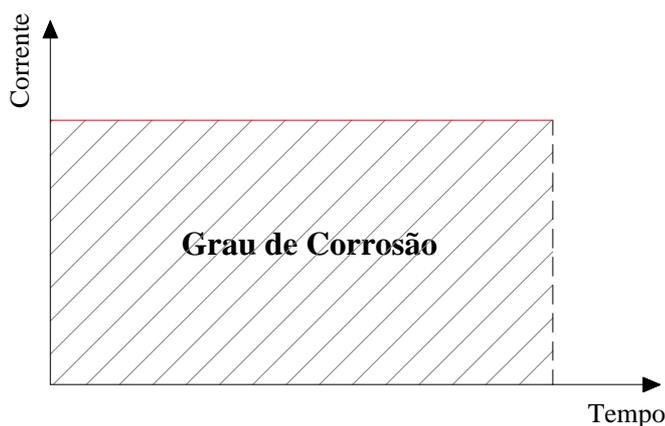
Figura 3.5 – Ilustração do uso da Lei de Faraday para determinação do grau de corrosão.
