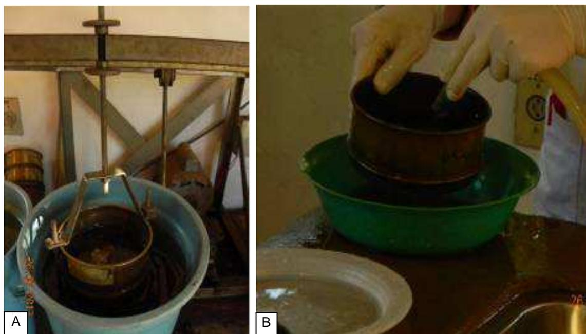
**Figura 7.** Detalhe: (A) agitador de oscilação vertical, (B) transferência das amostras com auxílio de jatos de água
