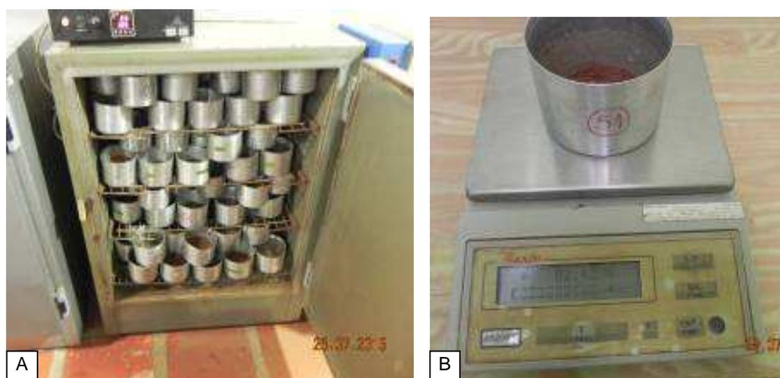
**Figura 8.** Detalhe: (A) secagem das amostras em estufa e (B) pesagem das amostras secas.
