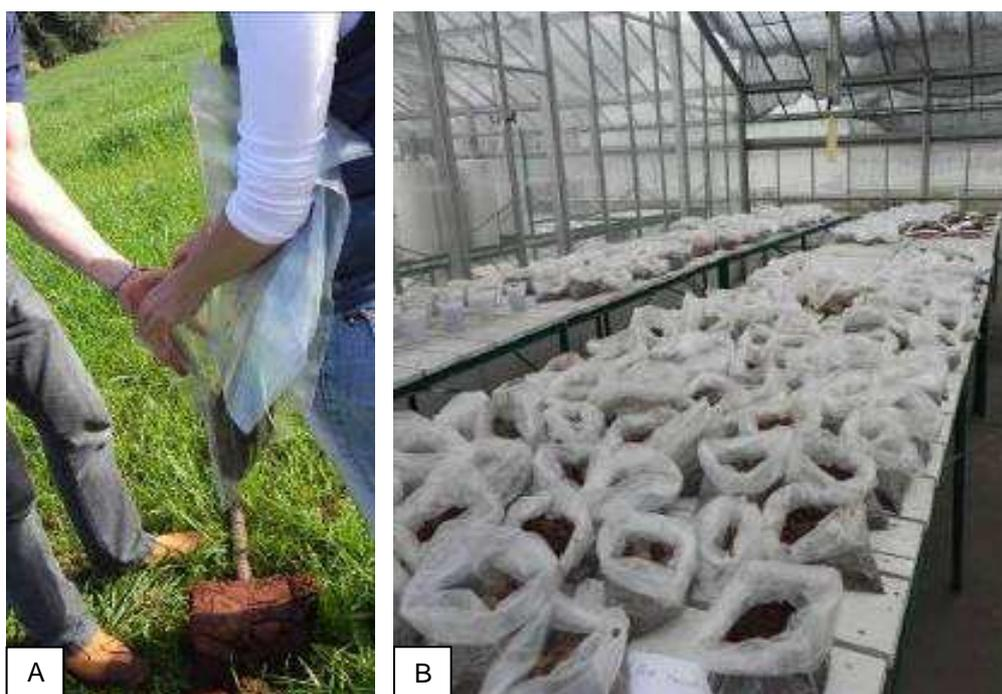
**Figura 6.** Detalhe: (A) armazenamento das amostras coletadas em sacos plásticos e (B) amostras dispostas em casa de vegetação para secagem.
