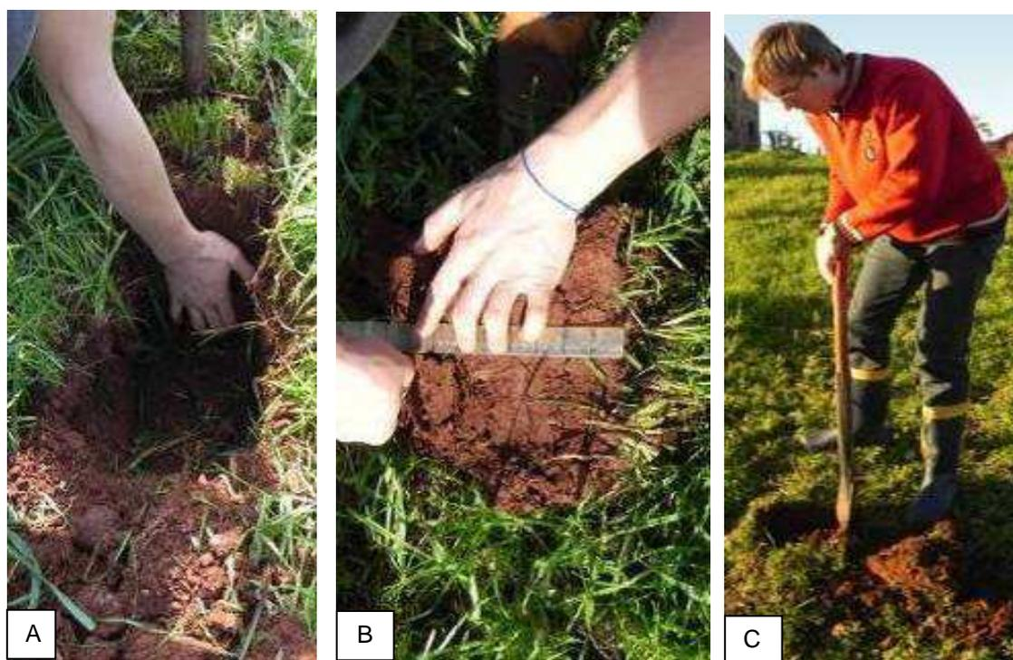
**Figura 5.** Detalhamento: (A) Coleta das amostras de solo da camada 0 – 0,20 m, (B) estratificação da amostra e (C) coleta das amostras de solo da camada de 0,20 – 0,40 m
