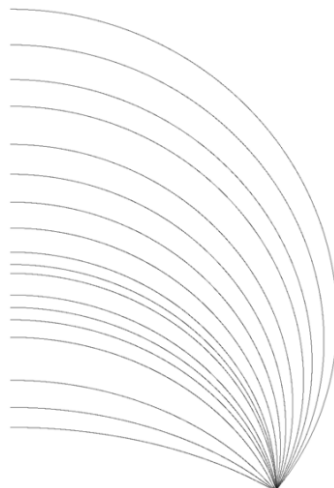
Figura 4.9: Sobreposição de diversas configurações da bolha ao longo do processo de inflação.
