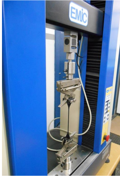
Figura 5.1 – Imagem da máquina de ensaio de tração simples realizando experimento
