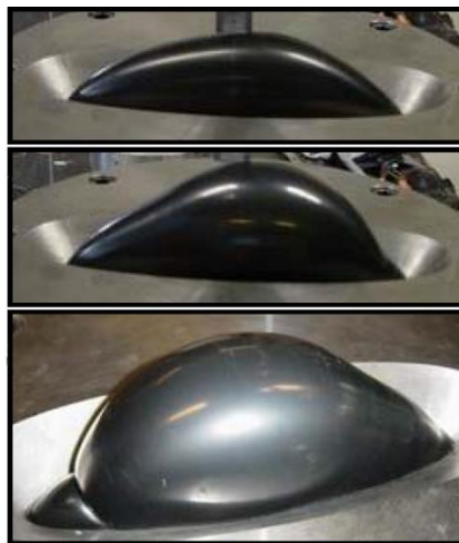
Figura 2.5 – Exemplos de bolhas mal geradas durante o processo de inflação.
