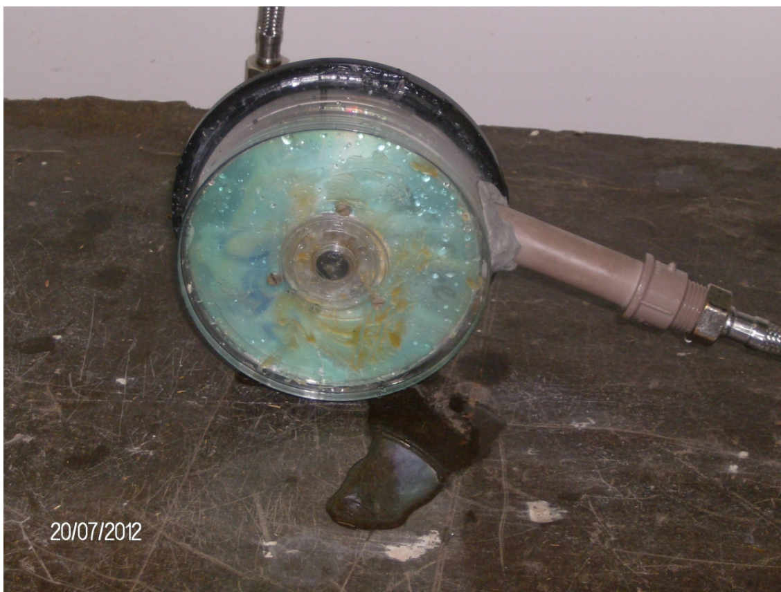
Figura 1- Montagem do primeiro protótipo de Turbina Tesla construído para ensaios
