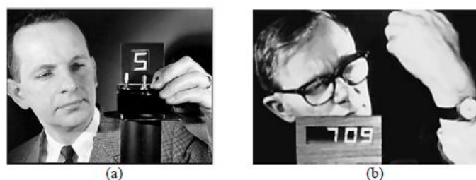
Figura 2 - Protótipos da RCA (a) Heilmeyer mostrando o primeiro LCD. (b) O primeiro relógio digital de LCD. 23
