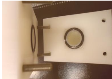
Figura 3.3: Fotografia do posicionamento da membrana polimérica entre as câmaras de difusão.
