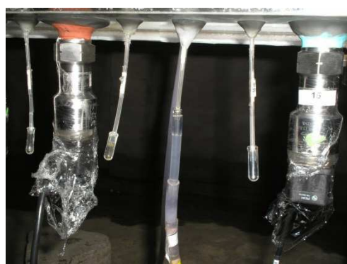
Figura 3.13 - Transdutores, piezômetro e furos não utilizados na base do conduto (parte elétrica protegida da água).
