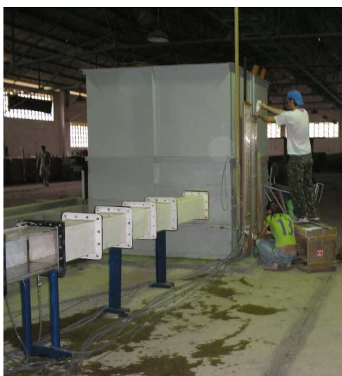
Figura 3.10 - Eliminação de ar dos piezômetros.
