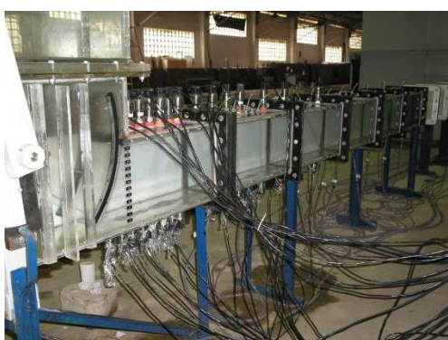
Figura 3.14 - Vista 1 da estrutura com os equipamentos de medição de pressão.
