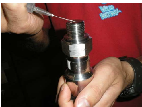
Figura 3.12 - Preenchimento com água do espaço do orifício da membrana do transdutor.
