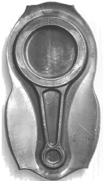
Figura 7.7: Peça forjada com geratriz de 110 mm de comprimento e 22,2mm de diâmetro
