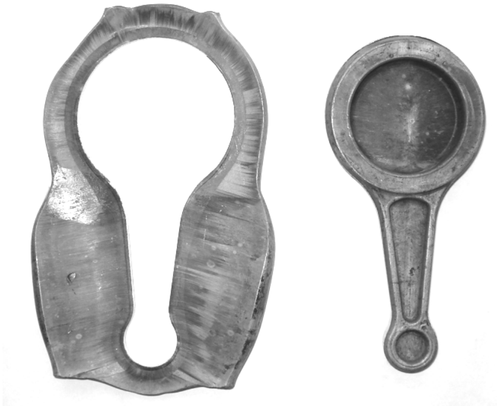
Figura 7.8: Rebarba retirada da peça e peça final
