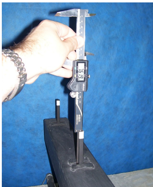
Figura 27: modo de medição das flechas
