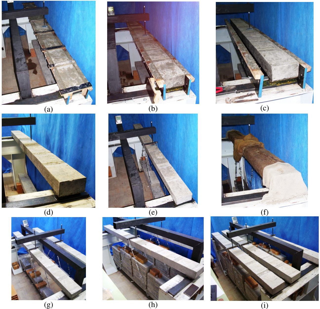
Figura 39: (a) viga V4d no aparato de ensaio com 1 dia de idade, (b) viga V4d em processo de desforma com 1 dia, (c) viga V4d quase desformada com 1 dia, (d) viga V4d totalmente desformada com 1 dia, (e) viga V4d com o primeiro carregamento com 1 dia, (f) viga V4d em continuidade do processo de cura com 1 dia, (g) vigas V4d e V7d parcialmente carregadas com 4 dias de idade, (h) vigas V4d e V7d totalmente carregadas com 28 dias de idade, (i) vigas V4d, V7d e V28d totalmente carregadas com 28 dias de idade.
