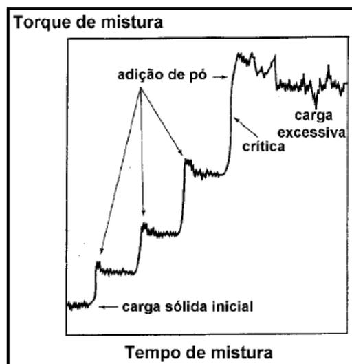
Figura 4. Variação do torque em função do tempo de mistura e adição de pó. Adaptado de Harima<sup>17</sup>.
