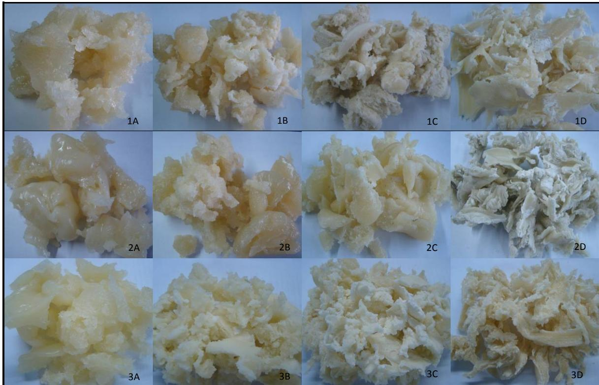
Figura 19. Amostras preparadas em câmara de mistura *Haake*. As letras identificam a quantidade de amido, sendo A, B, C e D correspondentes à 39, 49, 59 e 69% m/m, respectivamente. O número identifica a razão água:glicerol, onde 1 identifica a razão 1:1; o 2 corresponde à 1:2; e o 3 se refere a razão é de 2:1. (Tabela 3)
