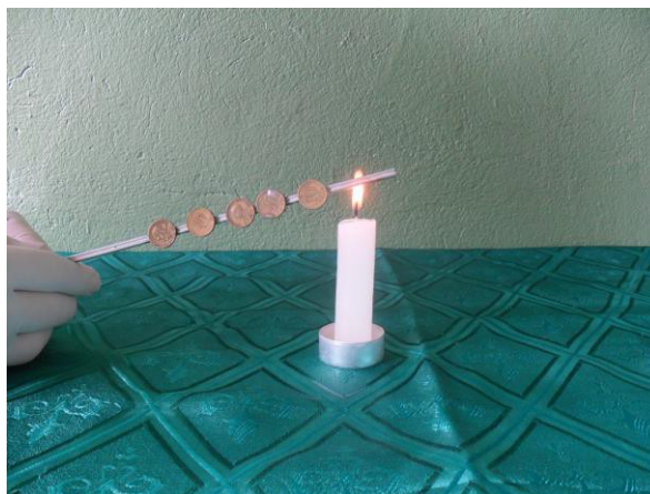
Figura 4: demonstração de condução térmica
