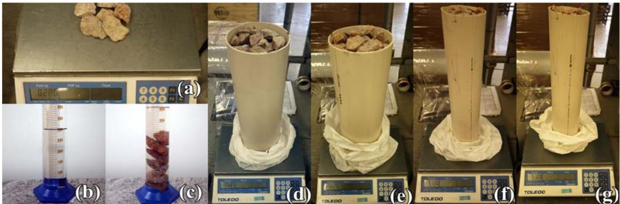
Figura 5.1 – Procedimento para cálculo da densidade do material. (a) pesagem da amostra; (b) volume inicial adicionado à proveta; (c) imersão da amostra no volume. Pesagem de diferentes amostras de agregados. (d) amostra 1 do agregado maior; (e) amostra 2 do agregado maior; (f) amostra 1 do agregado menor; (g) amostra 2 do agregado menor.
