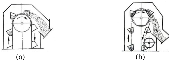
Figura 3.4: Elevador de canecas centrífugo: (a) sistema de descarga por força centrífuga e (b) sistema de descarga por ação da gravidade [Fonte: Spivakovskii, 1974].
