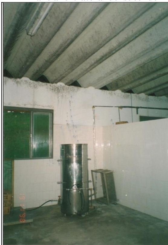
Figura 11 - Panela extratora de suco de frutas (capacidade para 72 kg de uva)
