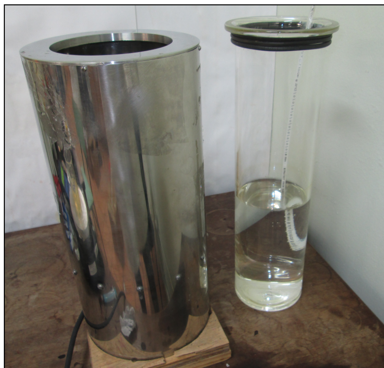
Figura 3 Estrutura de aço inox à esquerda e reator de vidro de borossilicato à direita
