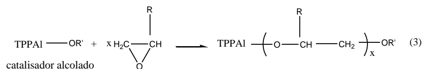
Figura 6. Polimerização do epóxido por um complexo de alumínio porfirina, TPPAlCl, associada ao metanol (R = H). 6
