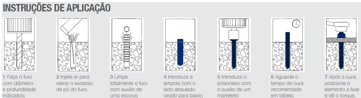
Figura 23 – Instruções de aplicação para chumbadores químicos
