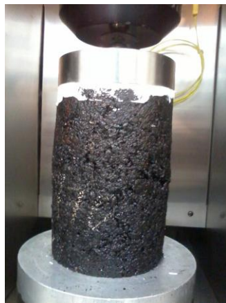
Figura 27 – Exemplo de CP após o ensaio uniaxial de carga repetida
