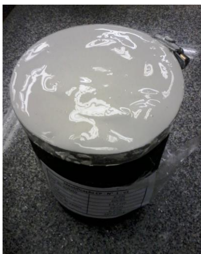
Figura 25 – Capeamento do CP com fina camada de gesso
