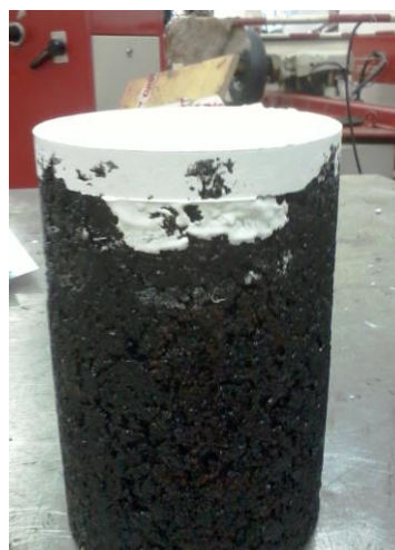
Figura 25 – Capeamento do CP com fina camada de gesso
