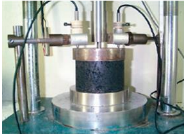
Figura 7 – Posicionamento dos LVDT sobre a placa de carregamento
