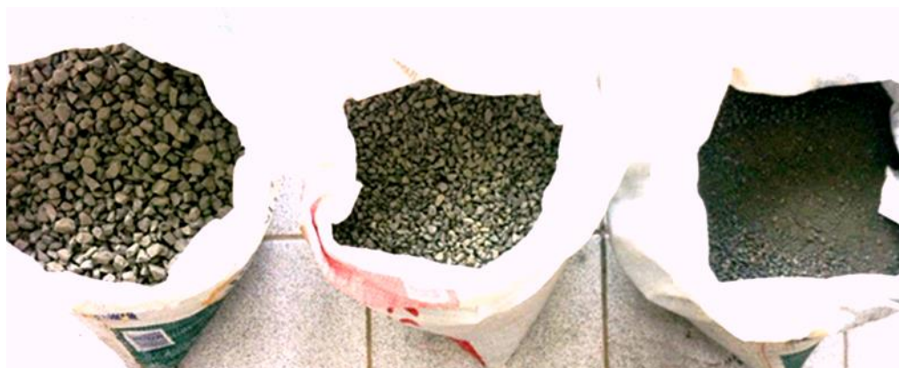
Figura 15 – Frações de agregados pétreos utilizados na pesquisa: 3/4”, 3/8” e pó de pedra
