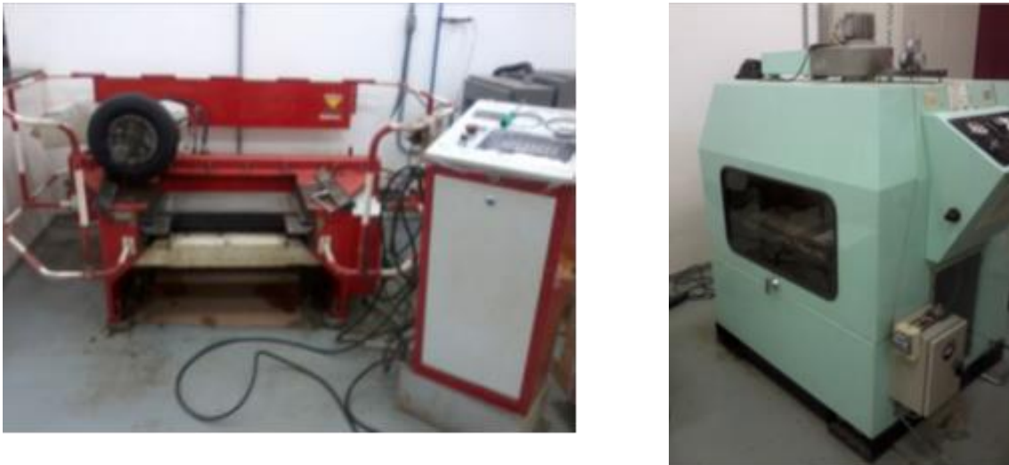
Figura 9 – Conjunto de mesa compactadora, simulador de tráfego LCPC para ensaios de deformação permanente em laboratório e placa de mistura asfáltica utilizada em ensaio
