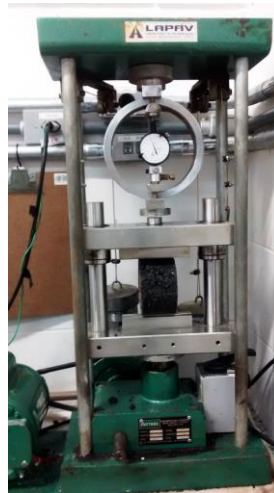
Figura 22 – Ensaio de resistência à tração por compressão diametral
