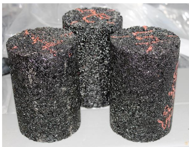
Figura 24 – CP compactado no compactador giratório
