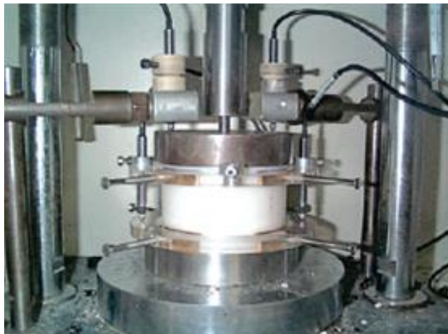
Figura 8 – Posicionamento dos LVDT acoplados ao corpo de prova
