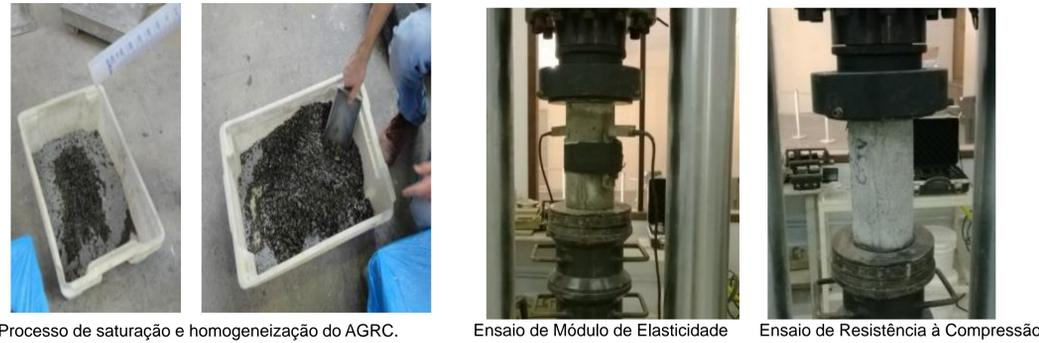
Processo de saturação e homogeneização do AGRC.
