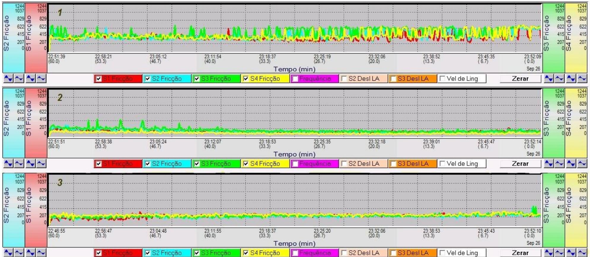
Figura 4.6 Gráfico exibido pelo *software* do sistema de acelerômetros da frenagem em função do tempo para os 3 (três) veios durante aplicação do fluxante B.
