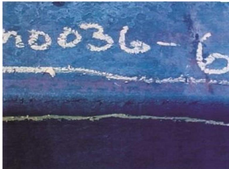
Figura 4.8 Superfície do tarugo com detalhe para trinca longitudinal de canto.
