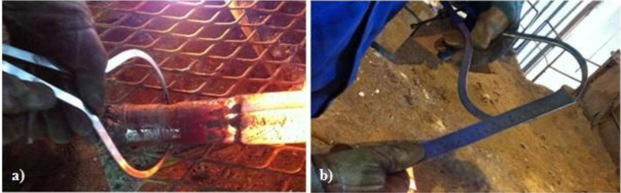
Figura 3.9 Ferramental para medição do desgaste circular de válvula submersa, na condição a) posicionamento da ferramenta e fixação de sua abertura e b) medição da abertura com uma régua simples.
