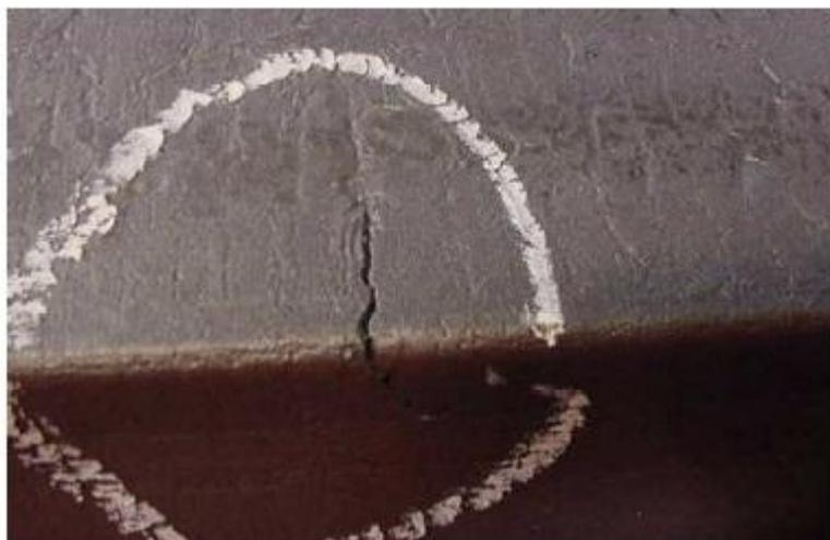
Figura 4.9 Superfície do tarugo com detalhe para trinca transversal de canto. Fonte: Adaptado de SILVA, 2012.
