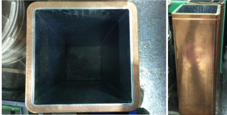
Figura 3.2 Molde de cobre para lingotamento contínuo de tarugos com seção quadrada de 240 x 240 mm.
