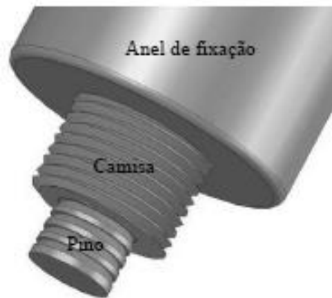
Figura 2.4 Ferramenta para soldagem FSpW composta por três partes concêntricas: Anel de Fixação, Camisa e Pino.
