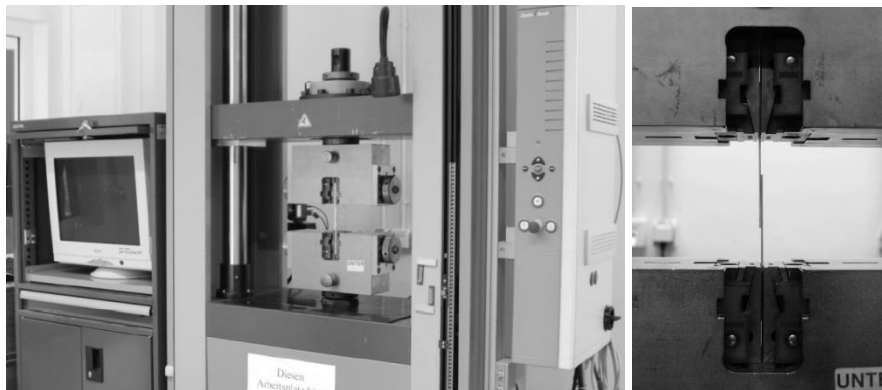
Figura 22 Máquina universal de ensaios mecânicos Zwick/Roell com capacidade de carga 200 kN e detalhe do posicionamento das chapas durante a execução do ensaio.
