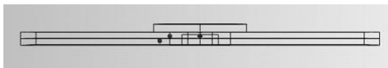
Figura 24 Pontos localizados na posição ocupada pelos termopares, utilizados para coletar dados para produzir o perfil térmico no software COMSOL 4.3.
