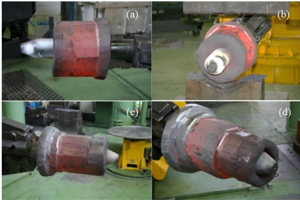
Figura 3.6 – Imagens do Processo forjamento (a) depois do terceiro passe, (b) antes do quinto passe, (c) primeiro recalque antes do sexto passe, (a) após sétimo passe.
