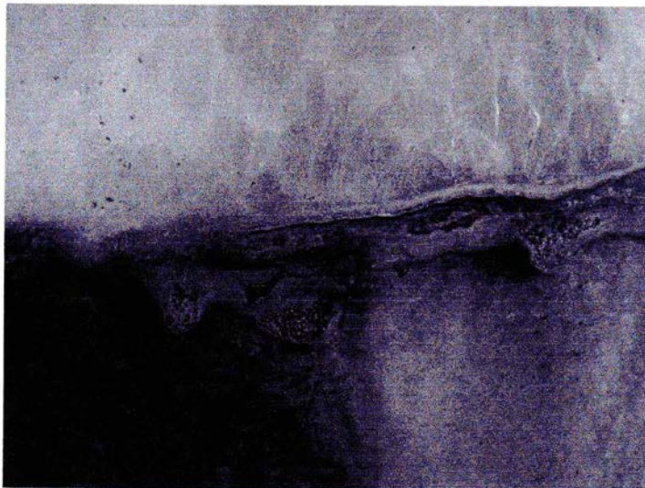
FIGURA 20 - Detalhe do acamadamento interno do cimento carbonático hidratado precipitado.
