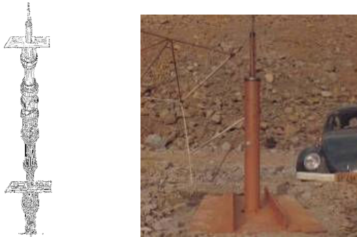
Figura 18: Medidor de recalque tipo KM com tubos telescópicos (fonte: Projeto do Aproveitamento Hidrelétrico de Itaúba – CI-C-25-38/1974) e Instalação da 1ª placa do medidor de recalque KM da Barragem de Itaúba (15/06/1976)
