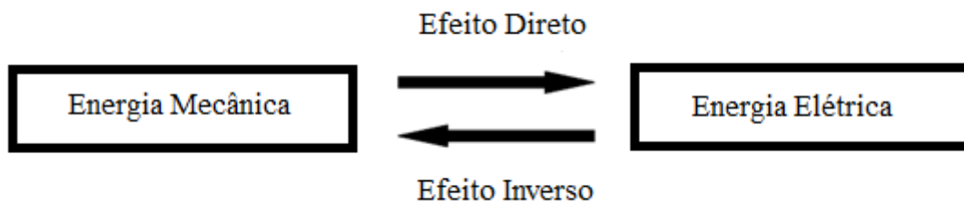
Figura 2.1 – Representação da conversão de energia no efeito piezelétrico.
