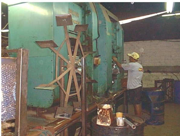
Figura 18: corte da barra extrudada, para a fabricação de telhas.
