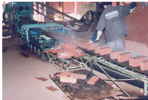
Figura 17: fase de extrusão automatizada, em indústria de grande porte, Esteio.
