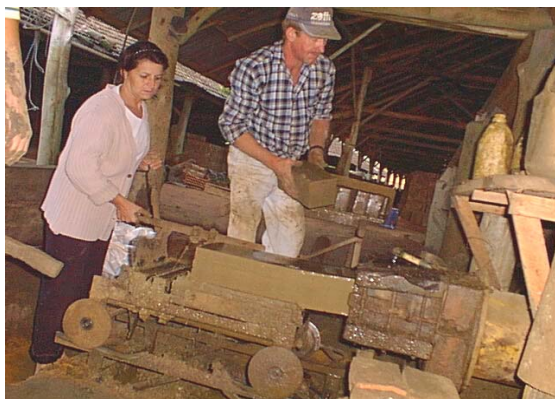
Figura 16: fase de extrusão manual, em indústria de pequeno porte, Barão.
