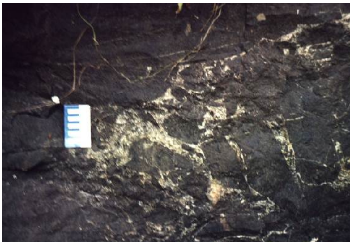
Figura 119 – Brecha hidráulica desenvolvida sobre rochas vulcânicas de estrutura maciça (afloramento 9 – Perfil Bento Gonçalves - Veranópolis).
