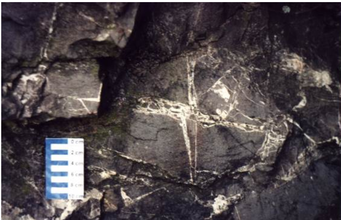
Figura 94 – Planos de fraturas e veios associados com brecha hidráulica do setor Veranópolis (Afloramento 1 – UTM 444940mE e 6787328mN e Afloramento 9 – UTM 445264mE e 6790645mN).
