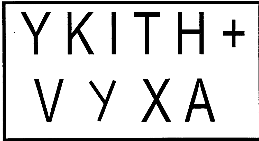
Figura 48 – Padrões de traços de fraturas descritos por letras conforme Dunne & Hancock (1994).
