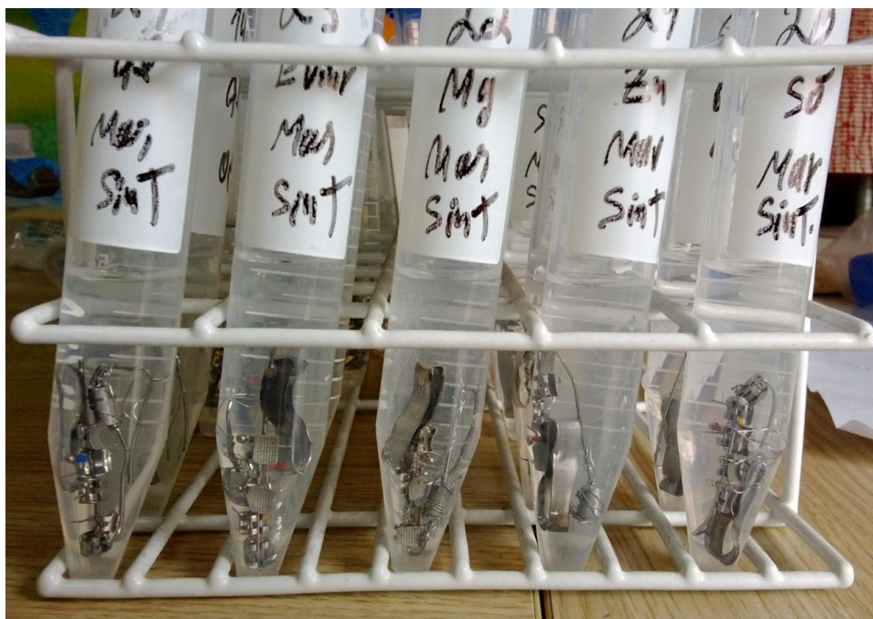
Figura 39 Amostras em 3,5% de NaCl no primeiro dia do ensaio.
