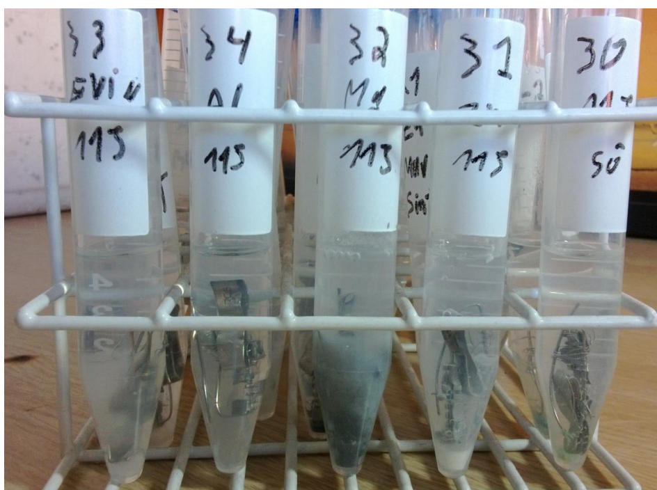
Figura 38 Reações entre os materiais e a solução após sete dias, com a solução de 11,5% de NaCl.
