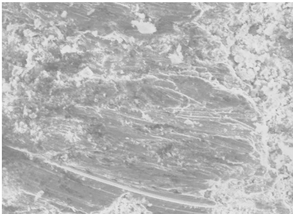
Figura 129 Anodo de sacrifício escovado após o ensaio, aumento 500x, arranjo CLFZN, amostra número 17, NaCl 0,9%+NaF 0,05%, com anodo de sacrifício de zinco.
