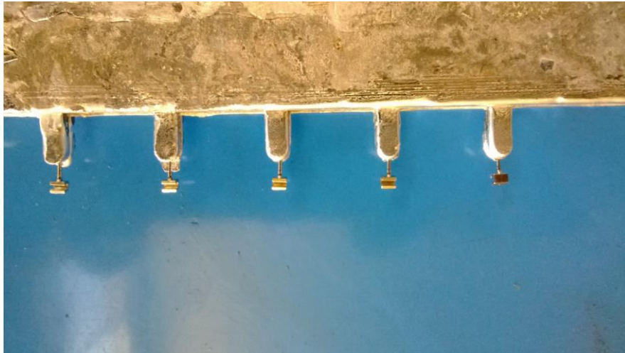
Figura 27 Canal de alimentação e anodos de sacrifício de magnésio com insertos de gancho bola.
