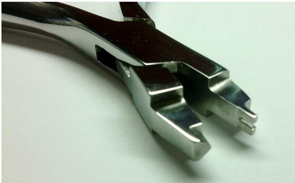
Figura 31 Alicate para prender o gancho bola ao arco.
