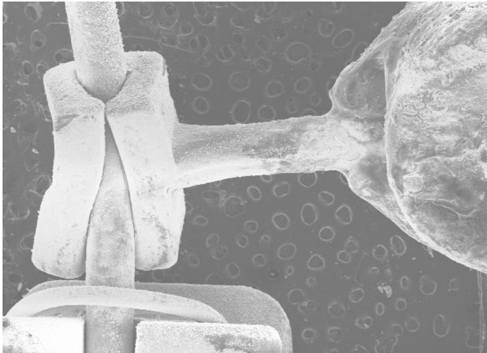
Figura 111 Anodo de sacrifício após o ensaio, aumento 20x, arranjo CLZN, amostra número 15, NaCl 0,9%, com anodo de sacrifício de zinco.
