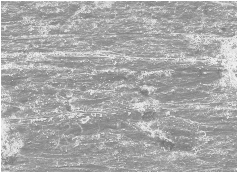
Figura 89 Anodo de sacrifício após o ensaio e escovado, aumento 100x, arranjo CLMG, amostra número 8, NaCl 0,9%, com anodo de sacrifício de magnésio.
