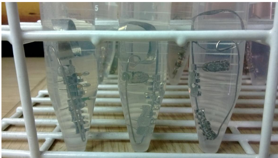
Figura 35 Amostras imersas nas soluções aquosas eletrolíticas.
