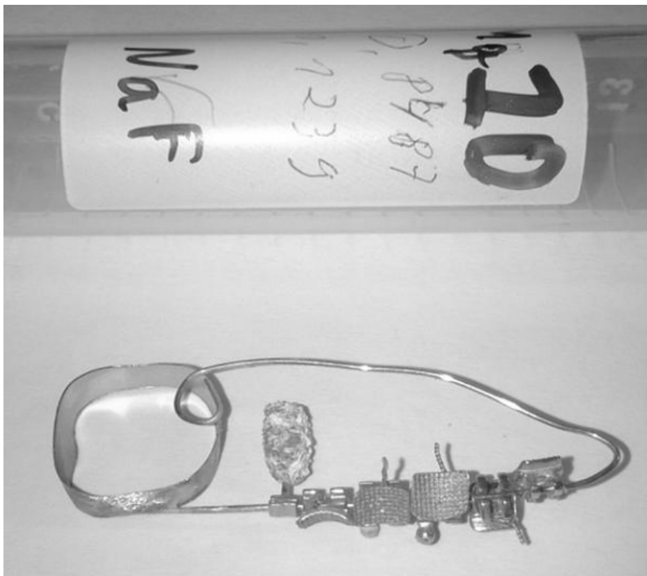
Figura 92 Arranjo CLFMG depois do ensaio, amostra número 10, em NaCl 0,9%+NaF 0,05%, com anodo de sacrifício de magnésio.
