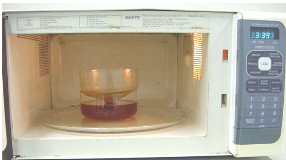
Figura 5.10 - Forno microondas carregado com a cera depois da deceragem (fim do ciclo).
