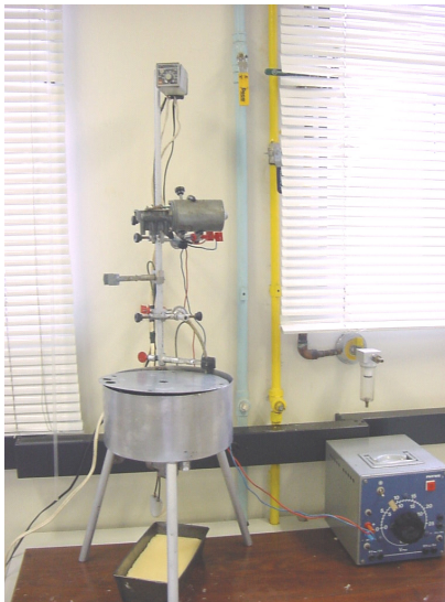
Figura 4.3 - Forno tipo poço dotado de sistema de agitação e controle de temperatura.
