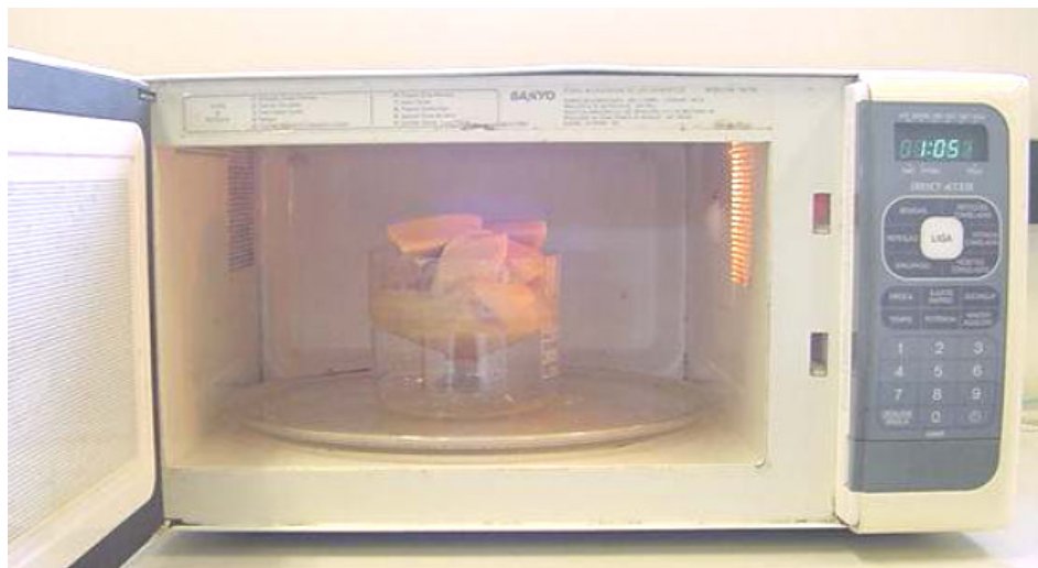
Figura 5.9 - Forno microondas carregado com a cera antes da deceragem (início do ciclo).
