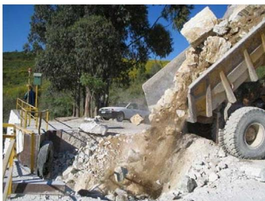
Figura 27 - Alimentação das instalações de britagem
