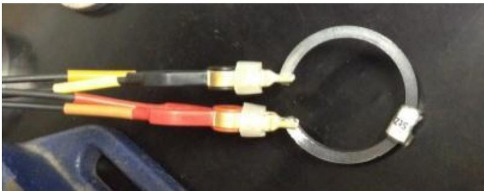
Figura 26 - Corpo de prova com corte conectado aos cabos para medição da resistividade
