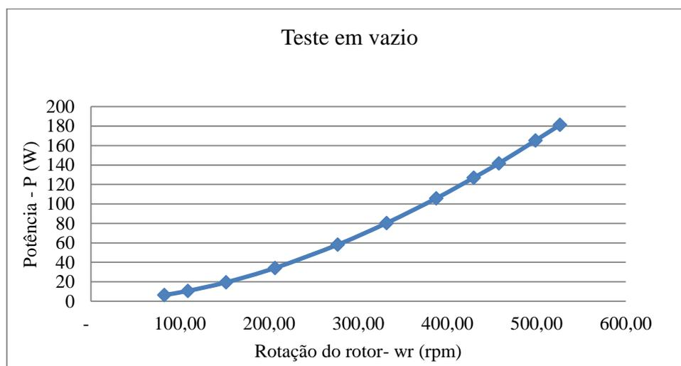
Figura 44 - Potência consumida acionamento do motor em vazio (Dados fornecidos pelo fabricante)
