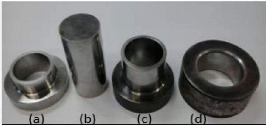
Figura 18 - Matriz para compactação dos corpos de prova na forma de anel [(a) - punção superior; (b) - matriz interna; (c) - punção inferior; (d) - matriz externa]
