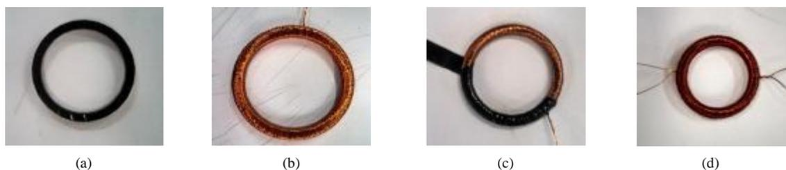
Figura 21 - Etapas de preparação das amostras: (a) isolamento, (b) enrolamento secundário, (c) isolando secundário e (d) enrolamento do primário.
