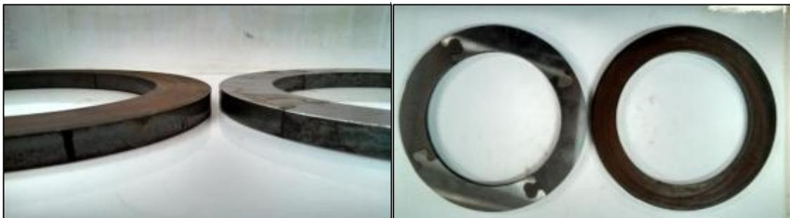
Figura 43 - Comparativo entre núcleo comercial (laminado) e núcleo com peças sinterizadas
