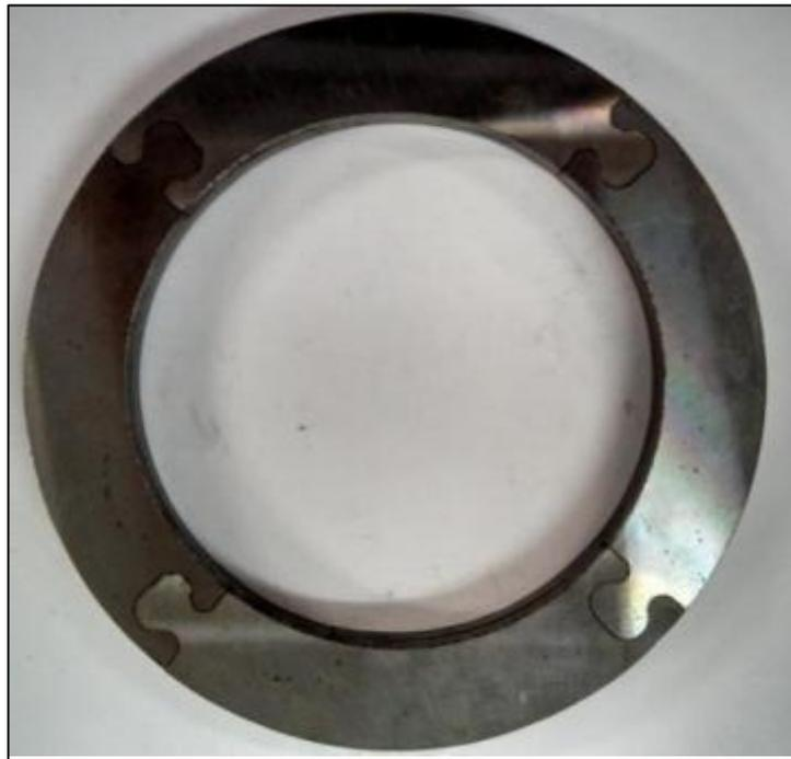
Figura 42 - Peças usinadas encaixadas formando núcleo do estator
