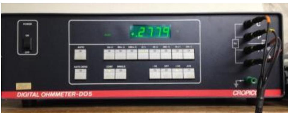
Figura 27 - Ohmímetro digital utilizado para a obtenção da resistência das amostras
