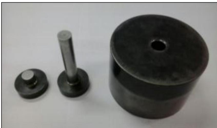
Figura 15 - Matriz para compactação dos corpos de prova na forma de cilindro
