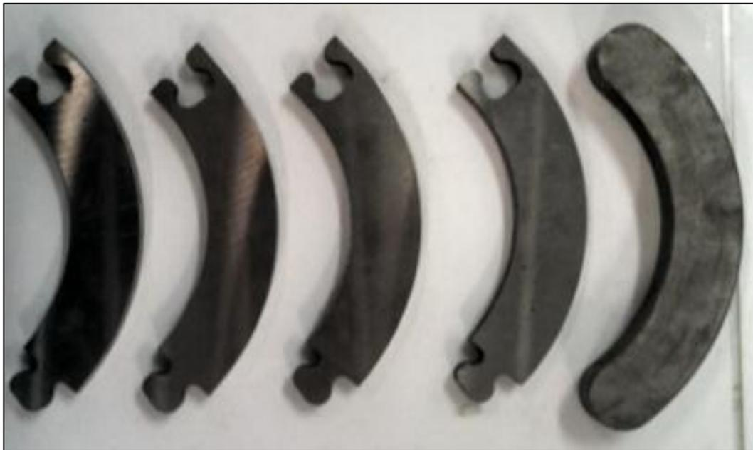
Figura 41 - Peça sinterizada comparando com as peças usinadas com os encaixes
