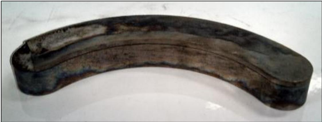
Figura 37 - Peça de Fe2%P que compõem o núcleo, após sinterização
