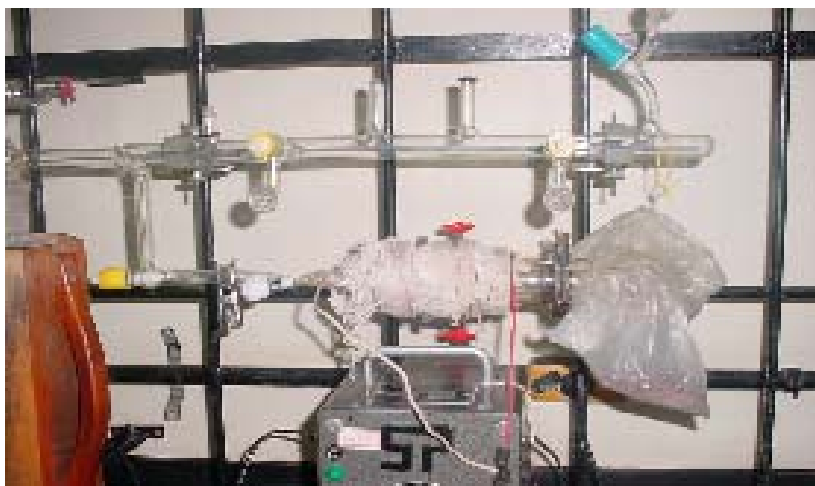
Figura 9. Aparato experimental usado na termoanálise no infravermelho.
