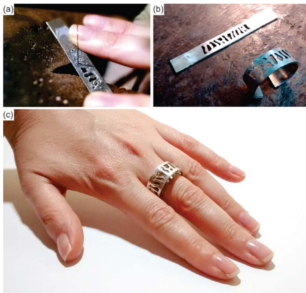
Figura 5: Joia desenvolvida: (a) processo de fabricação manual; (b) sobreposição de camadas; (c) peça final.
