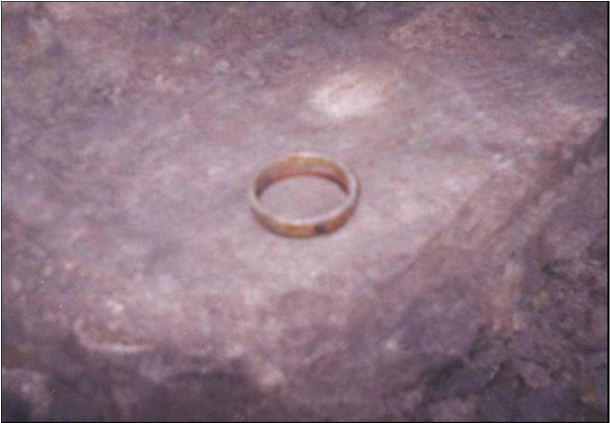
Figura 22: Colocação de um anel de adensamento com diâmetro 49,7 mm e altura 19,2 mm sobre a superfície escavada do solo de Santo Antônio da Patrulha
