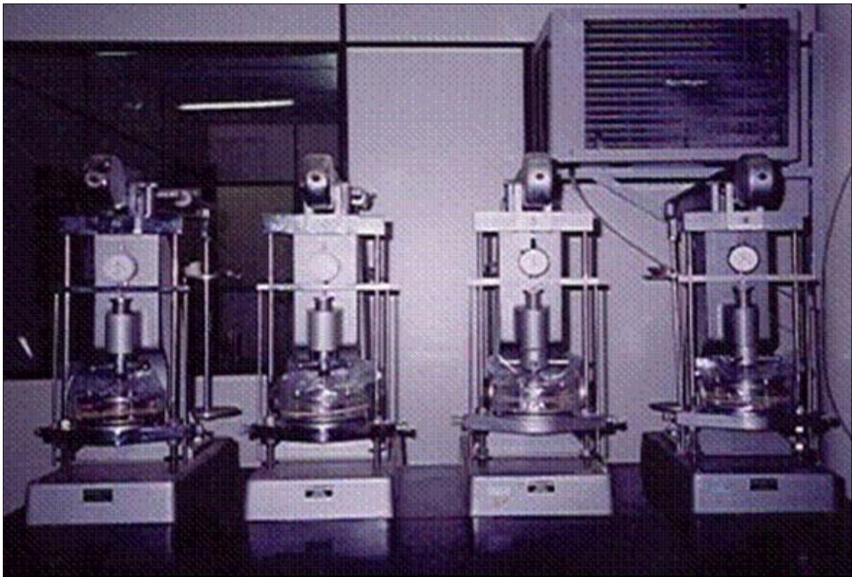
Figura 2: Vista frontal do equipamento oedométrico convencional, cujas características básicas foram padronizadas por Taylor (1942)
