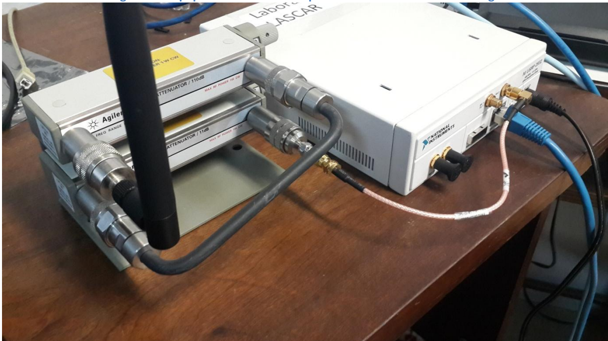
Figura 47: Equipamentos utilizados para o teste do sinal IEEE 802.11g.
