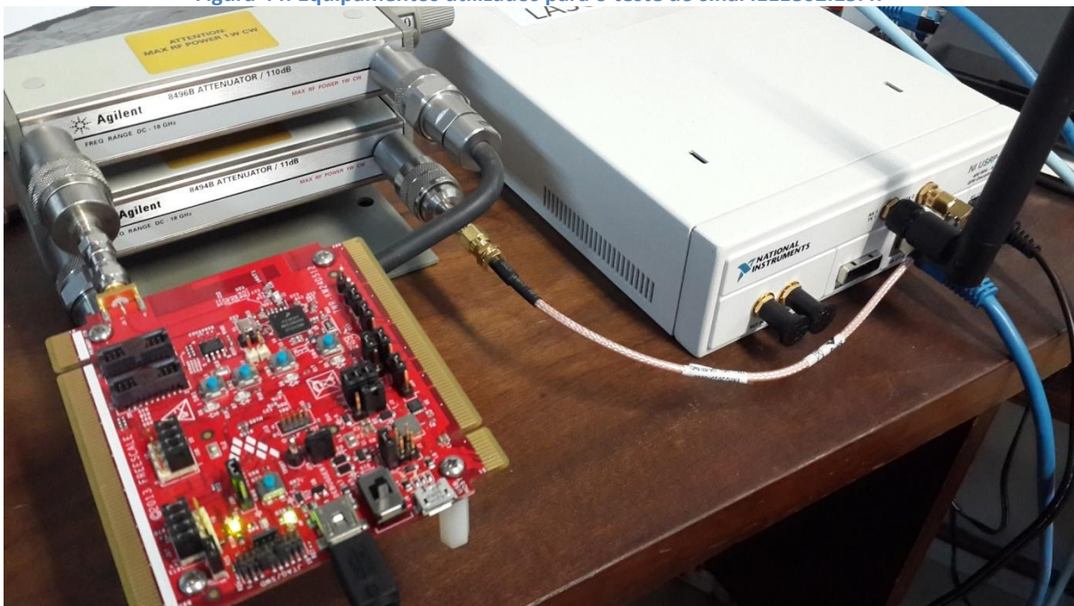
Figura 44: Equipamentos utilizados para o teste do sinal IEEE802.15.4.
