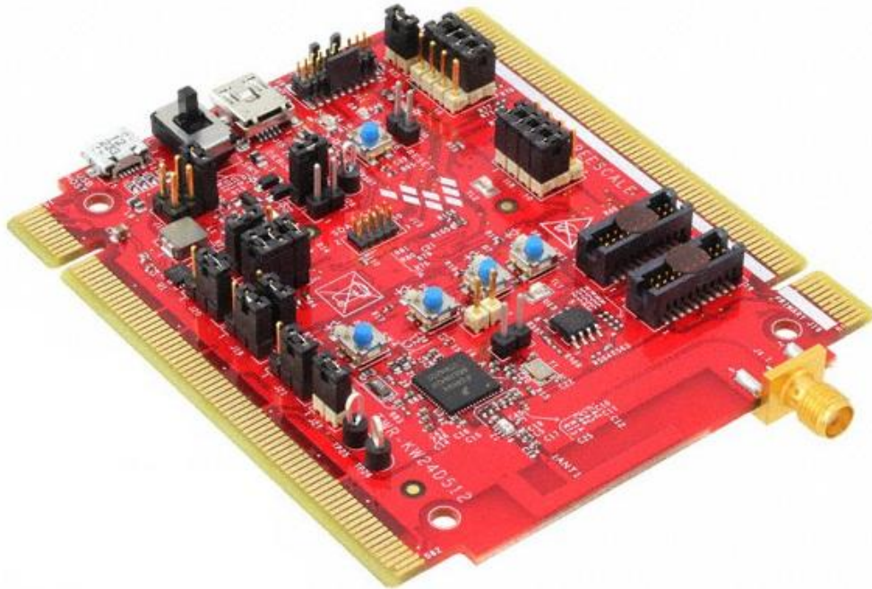
Figura 10: Placa de desenvolvimento para os testes com o padrão IEEE 802.15.4.
