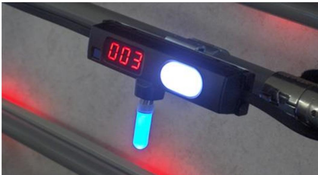
**Figura 18 – Exemplo de processo “pick to light” com confirmação de quantidade.
