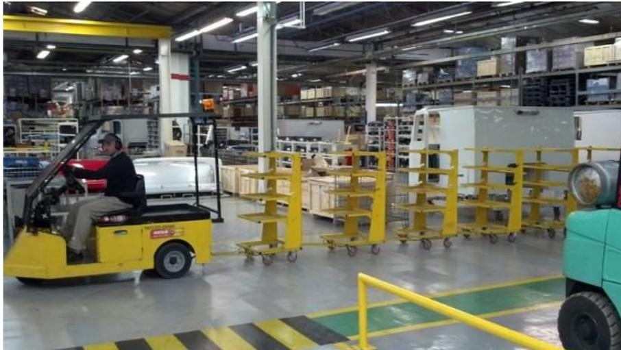
**Figura 32 – Movimentação de kits por rebocador elétrico**
