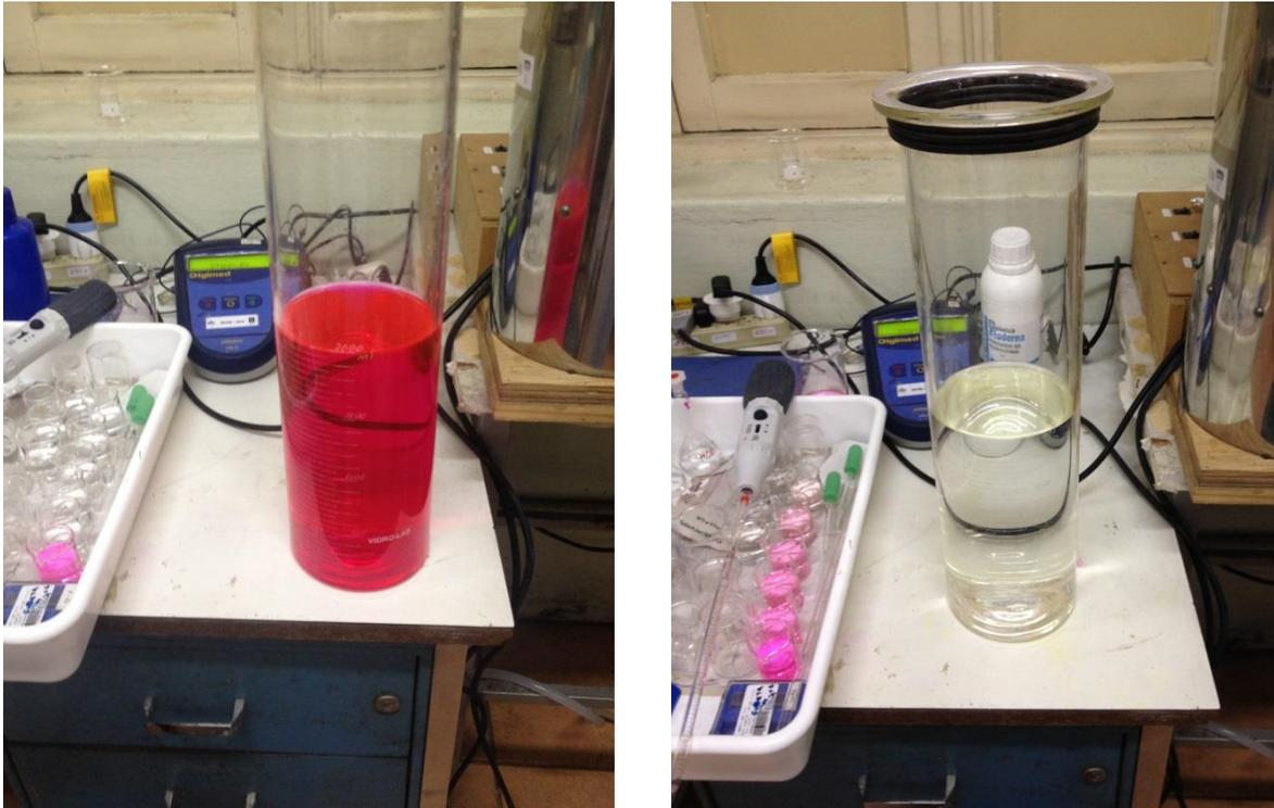
**Figura 9.** Solução de Rodamina B antes da reação foto-Fenton e após 60 minutos de reação, com  $0,53 \text{ mmol.L}^{-1}$  de  $\text{H}_2\text{O}_2$  e relação  $\text{H}_2\text{O}_2:\text{Fe}^{2+}$  de 10:1.
