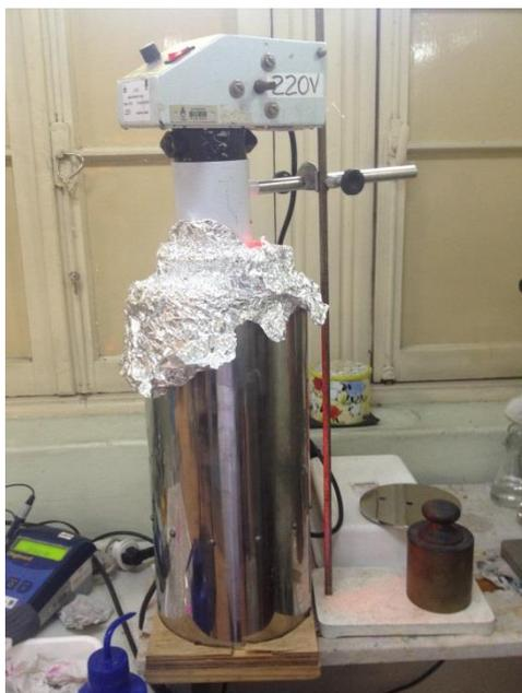
**Figura 2.** Fotografia do reator com luz UV utilizado nos experimentos em laboratório.
