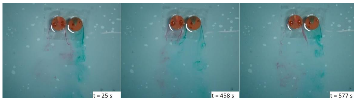
Figura 4.2 – Capturas do vídeo 3 relativas às configurações das esteiras com os respectivos tempos em que foram tomadas. Re_D = 1180 \pm 14 .
