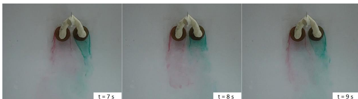
Figure 4.3 – Resultado do experimento com uma aleta a montante dos cilindros, com quadros de 7 segundos, 8 segundos e 9 segundos. Re_D = 1605 \pm 20 .
