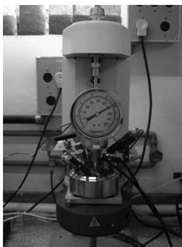
Figura 27. Reação de hidrogenação dos LIs com o catalisador Pd/C (5%) no Reator Paar.
