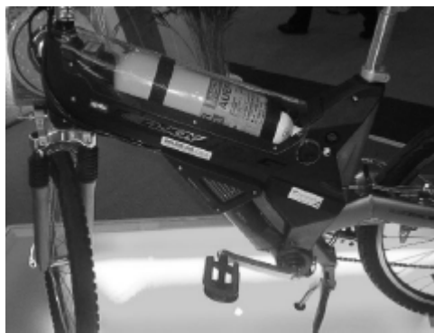
Figura 5. Armazenamento do hidrogênio sob a forma comprimida aplicado numa bicicleta elétrica. Fotografia retirada da referência 38.
