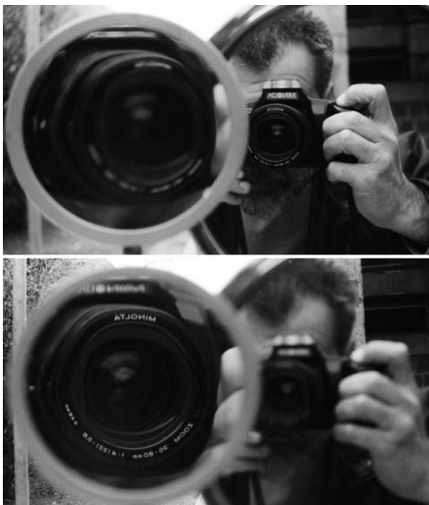
Figura 15 - Comparação do que se vê em um espelho plano com o que se vê em um espelho côncavo, posicionando a objetiva da máquina fotográfica no plano focal do espelho côncavo.
